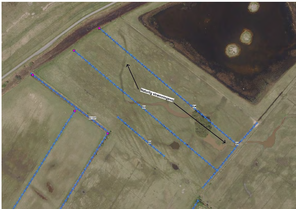
Figur 4.5.1 Udsnit fra delområde Q, hvor der er projekteret etablering af tærskler i to interne grøfter. Mellem disse ses en naturlig strømningsvej.
